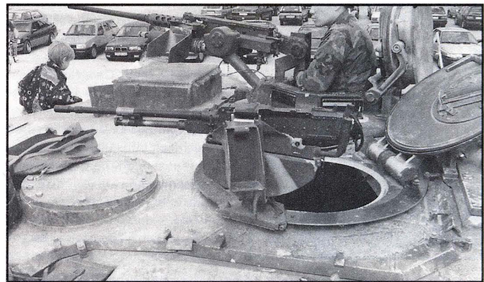
Details der Turmoberseite: Rechts die Ladeschützenluke, dahinter die Kommandantenkuppel. Vorn links der runde Sockel für das Thermo-Sichtgerät, dahinter die Abdeckung der Hauptoptik
